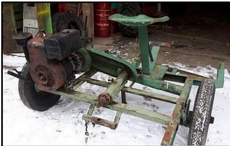
Koňská potahová jednotka s motorem (starší konstrukce):
