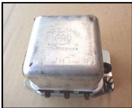
Releový regulátor 14V PAL Magneton 443 116 417.02 pro alternátory Škoda
