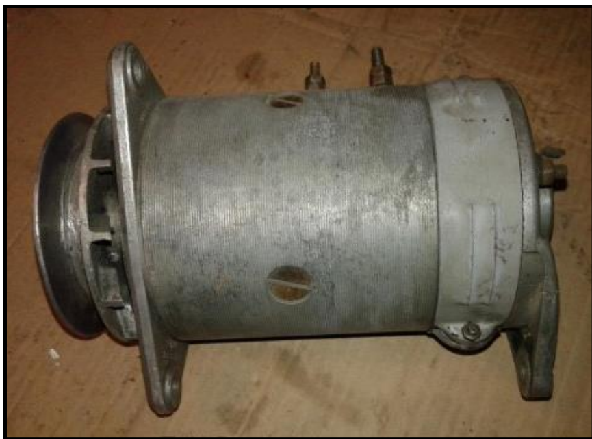
Automobilové dynamo =12V/22A
